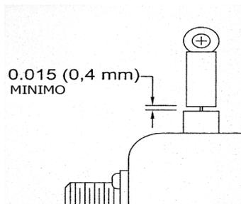
**Punto zero di estensione** Assicurarsi che il punto di partenza della fune non sia inferiore a 0,4 mm dalla posizione di estensione “zero”.
