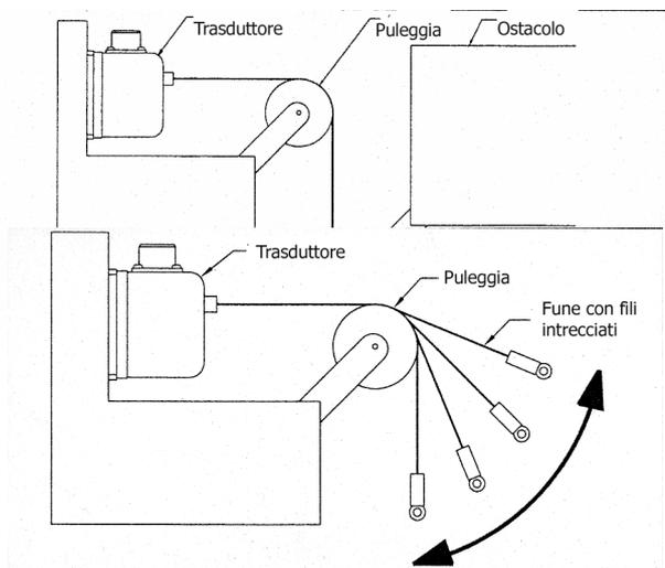
**Superamento di un ostacolo** La fune del trasduttore può essere instradata su una puleggia per facilitare il montaggio. Per allungare la vita della fune il diametro minimo della puleggia dovrebbe essere di 38 mm per un diametro della fune di 0,5 mm e di 64 mm per un diametro della fune tra 0,5 -1 mm.
