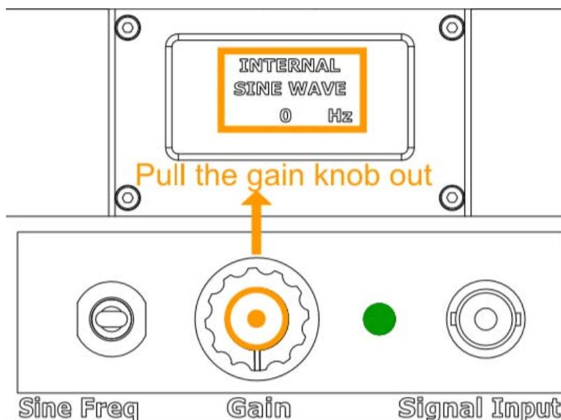
Alzare o abbassare l'interruttore del generatore di frequenza sinusoidale sulla frequenza sinusoidale desiderata.
