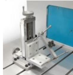
Serie AMF di Magtrol regolabile. I dispositivi di fissaggio del motore vengono utilizzati per proteggere motori di piccole e medie dimensioni durante l'esecuzione di qualsiasi test. Questi apparecchi estremamente versatili consentono inoltre un facile centraggio del motore per
