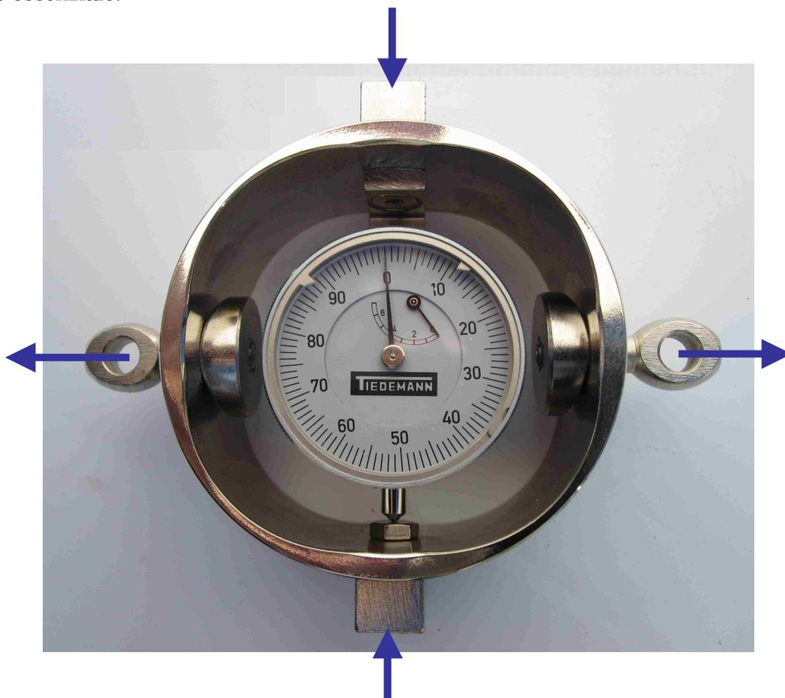
*Dinamometro universale con scala standard max. 2 kN*
